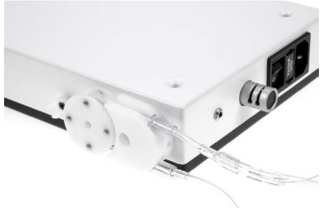
Abbildung 7 Schlauch korrekt um das Pumpenrad gelegt.
