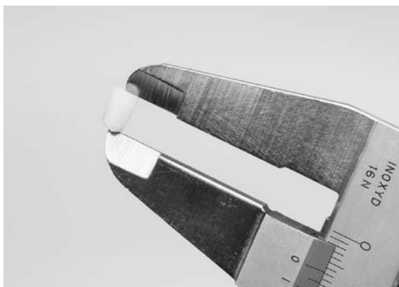
Figur 6 – Provbitens djup mäts
