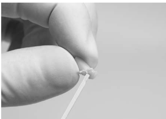
Figur 5 – Icke-polymeriserat material skrapas bort från provbiten
