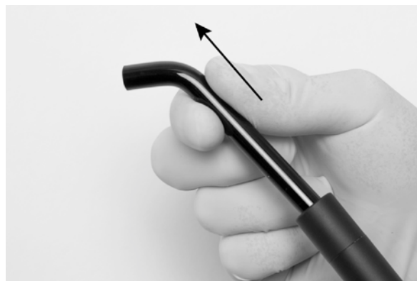
Figura 3 Retirar la barra de luz de la pieza de mano de XO ODONTOCURE
