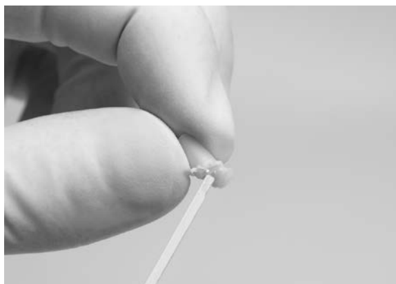
Figure 5 Le matériau non polymérisé est retiré du bouchon d'essai composite
