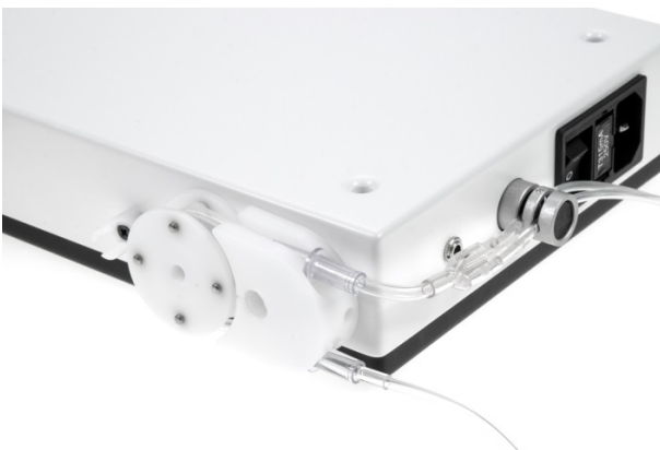
Figure 8 Placer les 2 tubes dans la vanne à pincement
