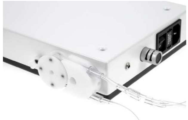
Figure 7 Tubes placés correctement autour de la roulette de pompe
